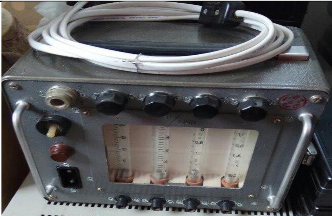
1.1 rasm. Laboratoriyalarda va karbamid tsexida atmosferaga chiqadigan ammyak miqdorini aniqlash uchun mo'ljallangan asperatorning 822-modeli
