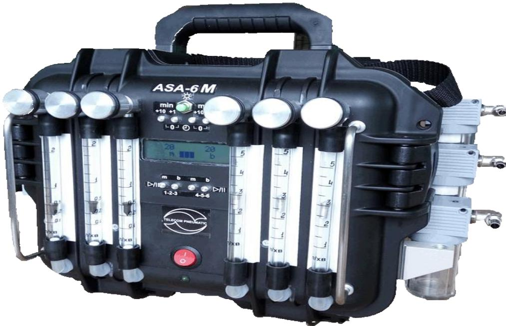
1.2 rasm Laboratoriyalarda va karbamid tsexida atmasferaga chiqadigan ammyak miqdorini aniqlash uchun mo'ljallangan asperatorning 6 kanalli turi
